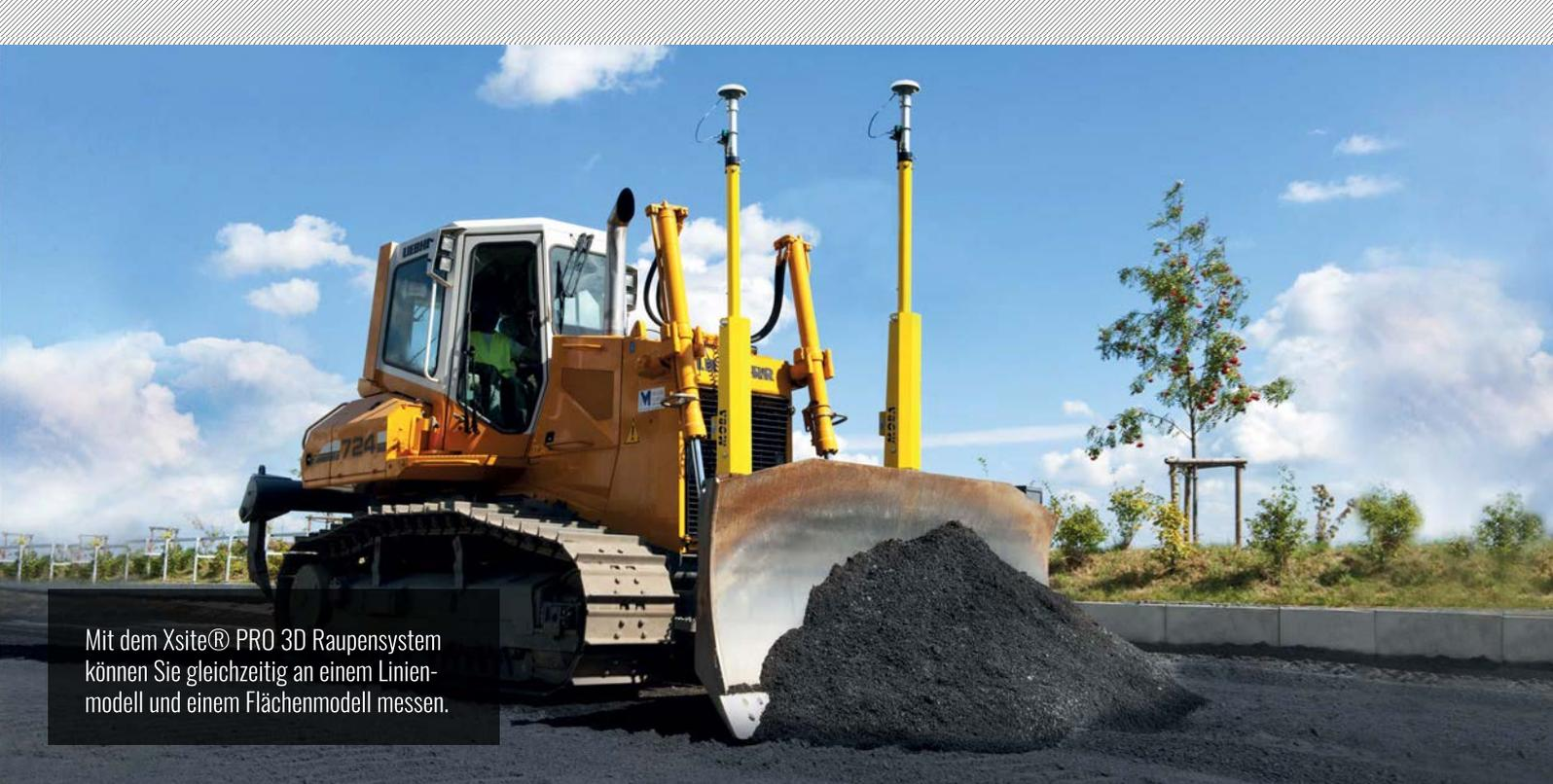
Mit dem Xsite® PRO 3D Raupensystem können Sie gleichzeitig an einem Linienmodell und einem Flächenmodell messen.
